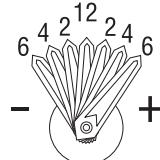
Для определения погодных условий механизм часов T-TOUCH SOLAR E81 учитывает изменения атмосферного давления в течение последних 6 часов. Помимо этого часы регистрируют резкое изменение давления, связанное с изменением высоты, и автоматически компенсируют его. Вследствие чего это изменение оказывает минимальное воздействие на прогноз барометра.
