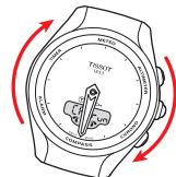
Повернуть компас более чем на один оборот на горизонтальной поверхности (например на столе) в помещении без магнитных возмущений со скоростью вращения около 30° в секунду.
